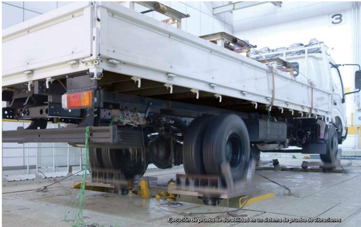
Ejecución de prueba de durabilidad en un sistema de prueba de vibraciones
