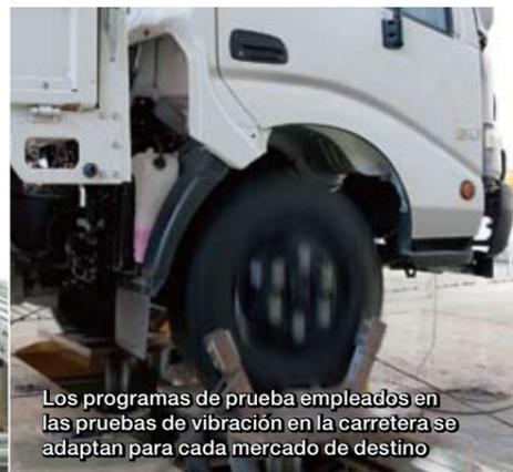
Los programas de prueba empleados en las pruebas de vibración en la carretera se adaptan para cada mercado de destino
