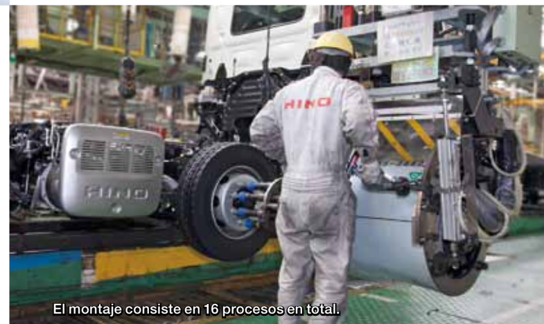
Pares de apriete de las tuercas de todas las ruedas se registran para rastreabilidad.
