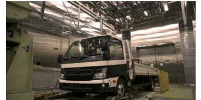
تم إجراء اختبارات التحمل في قاعة اختبار بيئية ذات درجات حرارة تتراوح من +50 درجة مئوية إلى -40 درجة مئوية.
