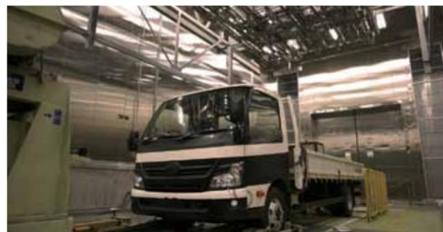
Se realizaron pruebas de durabilidad en una cámara de prueba ambiental bajo temperaturas de +50 a -40°C.
