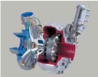
Los camiones adquieren su potencia de turbos adicionales que han sido equipados para áreas montañosas, donde la concentración de oxígeno es baja.
