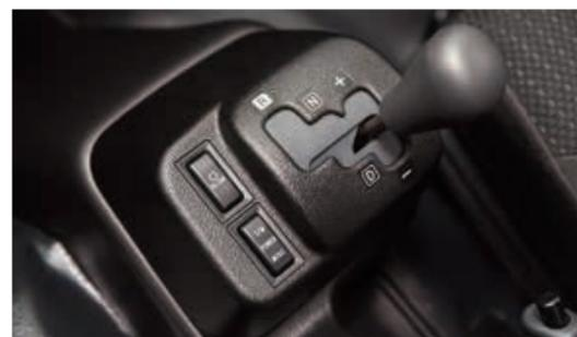
Les boîtes de vitesses ProShift équipant les véhicules Hino changent automatiquement les vitesses pour la plage offrant la meilleure économie de carburant.
