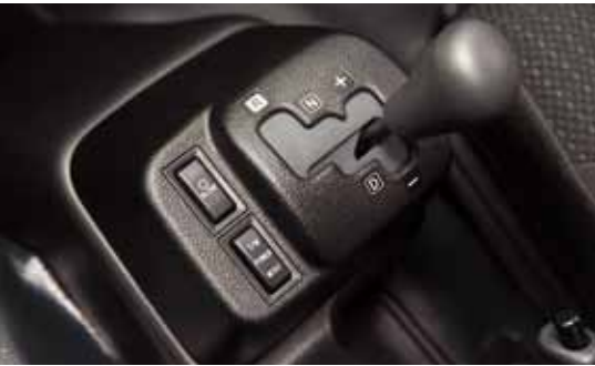
Transmisi ProShift yang dipasang di kendaraan Hino secara otomatis memindah gigi ke rentang penghematan BBM yang optimal.
