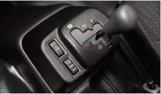
การเชื่อมต่อของ ProShift ที่ติดตั้งบนรถ Hino เปลี่ยนเกียร์ได้อัตโนมัติเพื่อให้ได้ผลลัพธ์ที่ดีที่สุดในการประหยัดน้ำมัน
