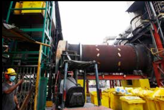
เตาเผาขยะสำหรับกำจัดของเสียทางการแพทย์ ของเสียทางการแพทย์จะถูกเผาไหม้หลังจากถูกขนส่งมาที่นี่ ส่วนขยะที่ไม่สามารถเผาได้ก็จะถูกเก็บไว้เป็นคลังสินค้าเย็น
