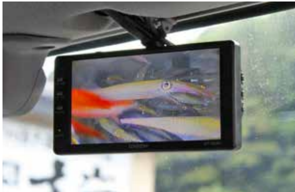
تزود شاشة العرض الموجودة أعلى مقعد السائق رؤيةً داخليةً للخزان.
