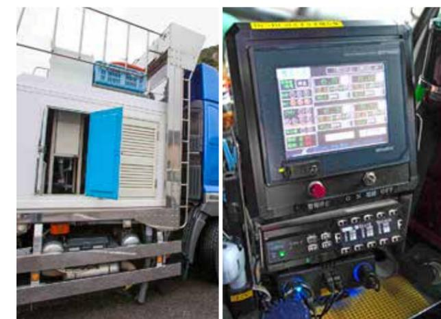
Le système de filtrage a été conçu pour être compact. Ce moniteur permet au conducteur de vérifier l'état du système de filtrage.
