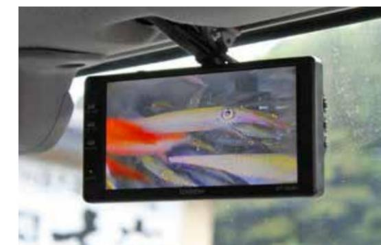
L'écran au-dessus du siège du conducteur fournit une vue de l'intérieur du réservoir.
