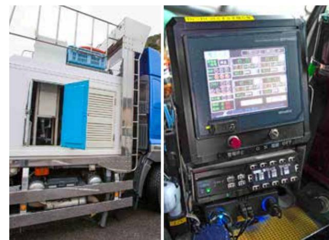
過濾裝置設計得很緊湊。坐在駕駛室就可以通過顯示器掌握過濾裝置的狀況。
