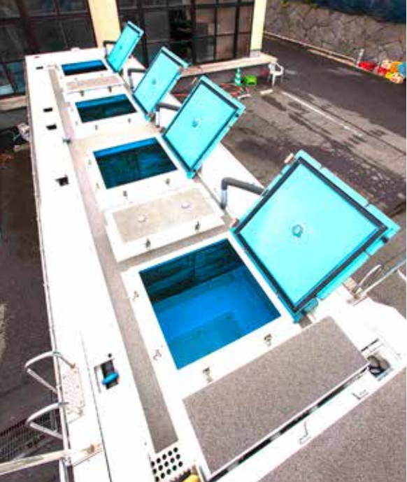
แท็งก์น้ำ 4 แท็งค์ที่ติดตั้งอยู่บนรถบรรทุก
