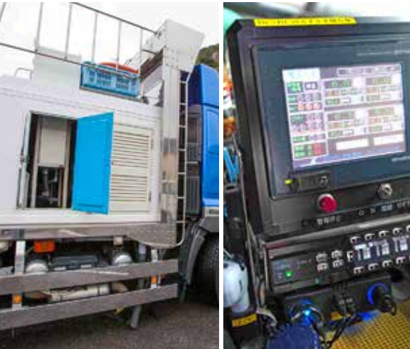
ระบบเครื่องกรองถูกออกแบบมาให้มีขนาดกระทัดรัด สามารถตรวจสอบเช็คสถานะของระบบเครื่องกรองได้จากมอนิเตอร์ตรงที่นั่งคนขับ
