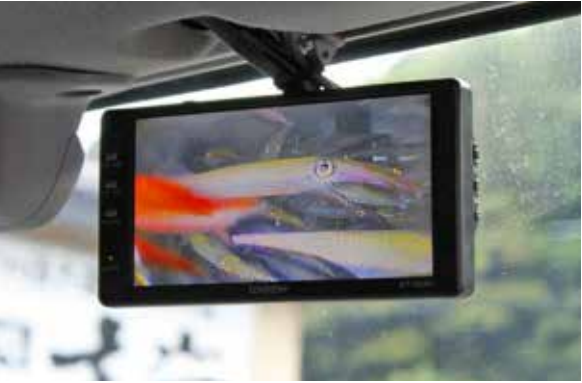
สามารถตรวจสอบสถานะของน้ำในแท็งก์น้ำได้จากจอแสดงผลด้านบนของที่นั่งคนขับ
