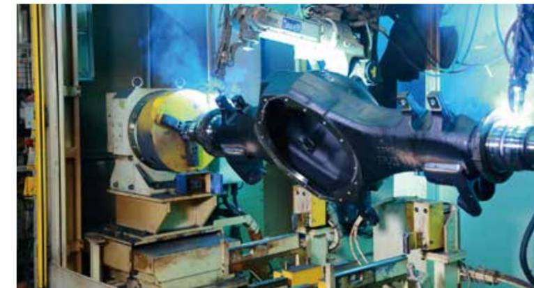
Montaje del eje y soldadura de lámina gruesa que reduce la distorsión
