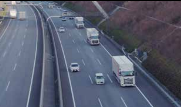
2018年1月，由日本4家商用車的製造商，高速公路上所共同實施，卡車列隊行駛的實際情況。
