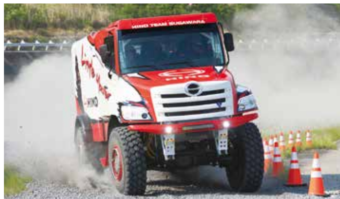
為爭奪組別總排名而開發，基礎性能有所提升的新型賽車。首次採用扭力轉換器式AT，以提高加速性能
