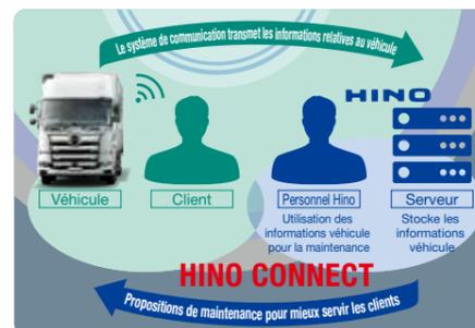
C'est en avril 2017 que Hino a lancé le service HINO CONNECT, basé sur les technologies de l'information et de la communication (« ICT » en anglais). Ce service utilise des terminaux embarqués pour suivre l'état des véhicules, dans le but de maximiser le temps de fonctionnement des camions et bus Hino. Les informations de localisation du véhicule et les différentes fonctions de notification sont utilisées afin de permettre une réaction rapide en cas de problème ou d'urgence.
