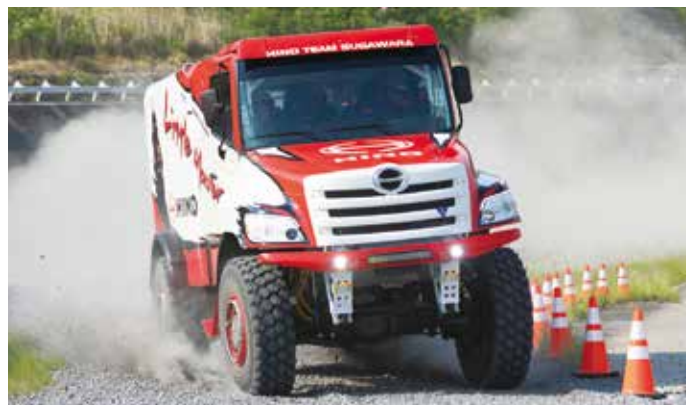
Новый грузовик для ралли «Дакар» с улучшенными характеристиками, призванный обеспечить победу в общем зачете на ралли «Дакар». Грузовик оборудован гидротрансформатором для более высокого ускорения.
