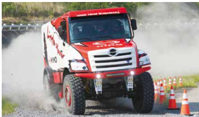
รถบรรทุกรุ่นใหม่สำหรับการแข่งขันได้รับการปรับปรุงสมรรถนะพื้นฐานให้ดียิ่งขึ้น เพื่อให้สามารถทำความเร็วได้เป็นอันดับต้น ๆ โดยติดตั้งระบบเกียร์อัตโนมัติแบบคอนวอร์เตอร์เป็นครั้งแรกเพื่อเพิ่มอัตราเร่ง
